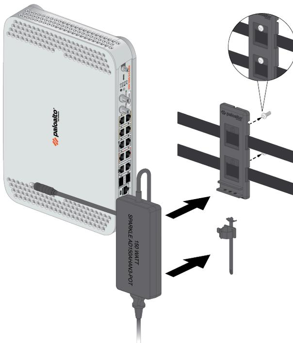
以下為配備單一電源轉換器的 ION 1200-S 安裝完成圖。如果您需要第二個電源供應器，則需要另外訂購電源轉換器和轉換器壁掛套件。
